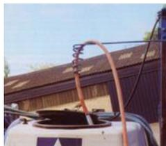
Il est obligatoire de mettre en œuvre un moyen de protection du réseau d'eau ne permettant **en aucun cas le retour de l'eau vers le circuit d'alimentation** :
